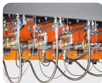
Aufgeräumtes Zylinderkühlkonzept mit wartungsfreien High-End-Ventilen
